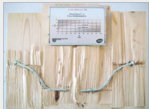
experimentální výsledky na spoji realizovaném pomocí řezných vrtů HBS na „Università degli studi di Trento“.
